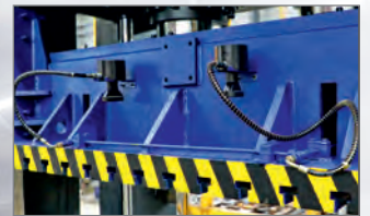
Quick Die Hydraulic clamping
